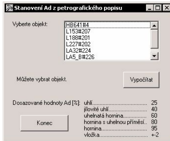
Obr. 2: Výběr objektu a výpočet obsahu popela A^d na základě petrografického popisu hornin
