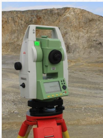
Univerzálna meračská stanica Leica FlexLine TS 02.
