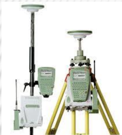
GNSS prístroj Leica GPS 900 CS.
