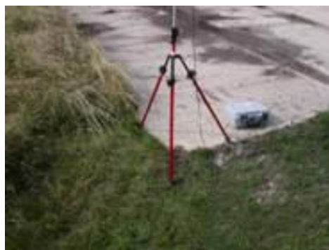
Obraz 1. (v ľavo) Ukážka bodu s presne určenými geodetickými súradnicami
