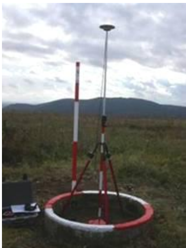
Obraz 1. (v ľavo) Ukážka bodu s presne určenými geodetickými súradnicami
